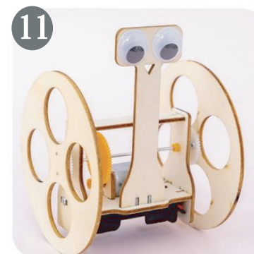
11. 安裝好車輪，兩個車輪需同時安裝。安裝時白色齒輪與側板需要留0.5mm左右的空隙，橙色固定圈與側板同樣要留0.5mm空隙，平衡車機器人製作完成。
